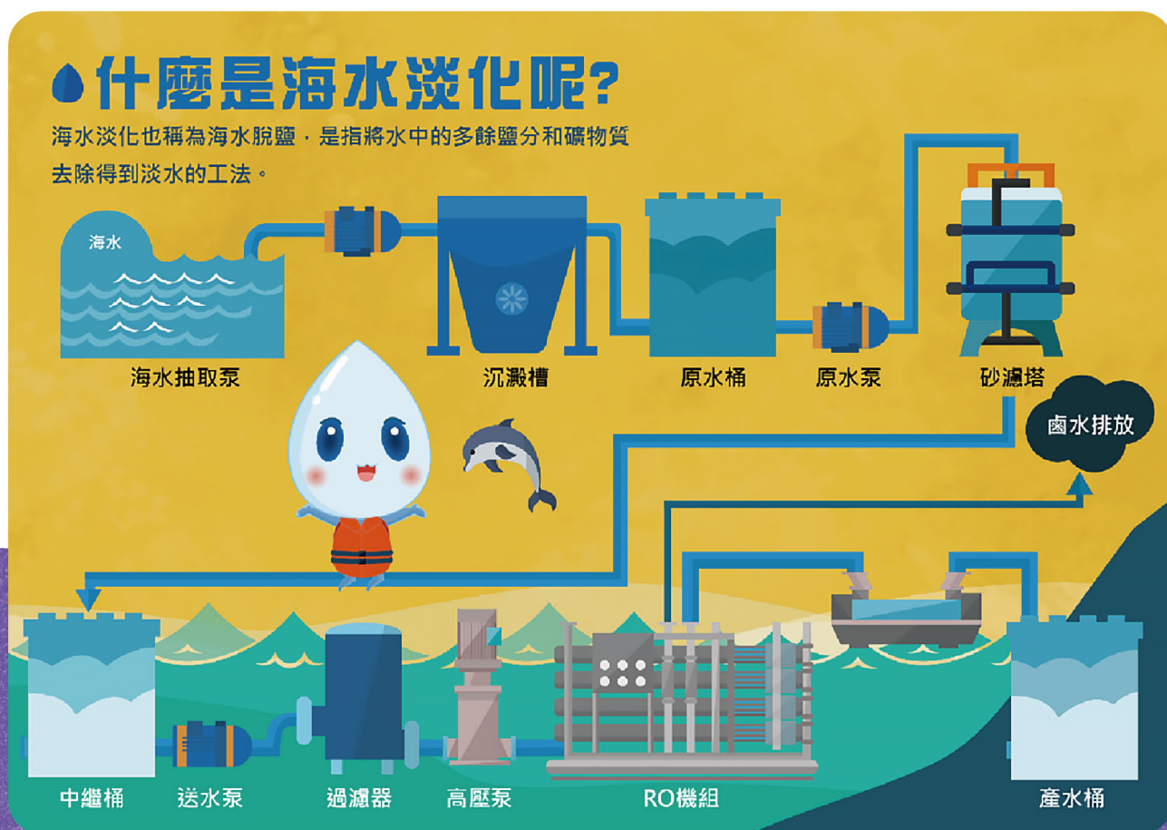
圖3-10 海水淡化流程圖
